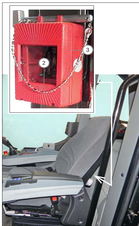
Figure 105: Coffret de sécurité
