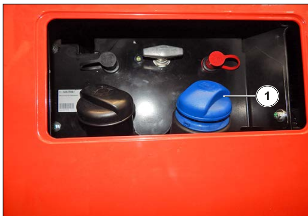
Figure 122: Remplissage du réservoir de DEF
