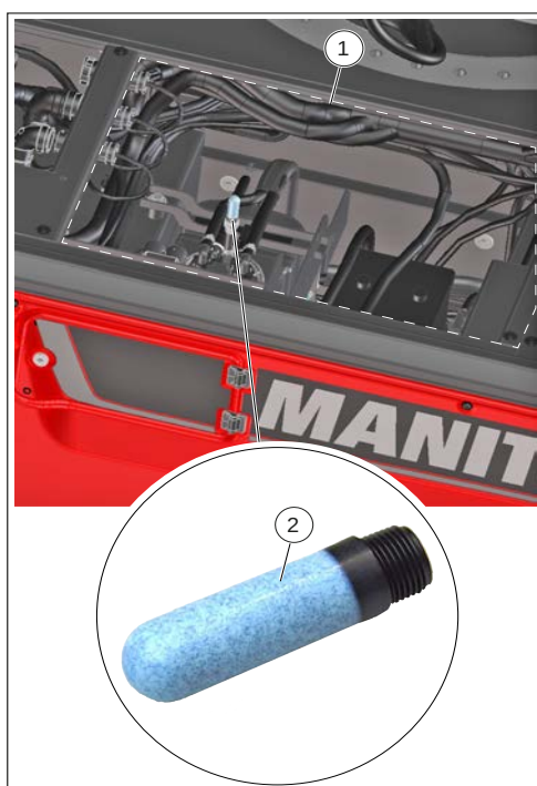
Figure 205: Remplacement du reniflard du réservoir de « DEF »
